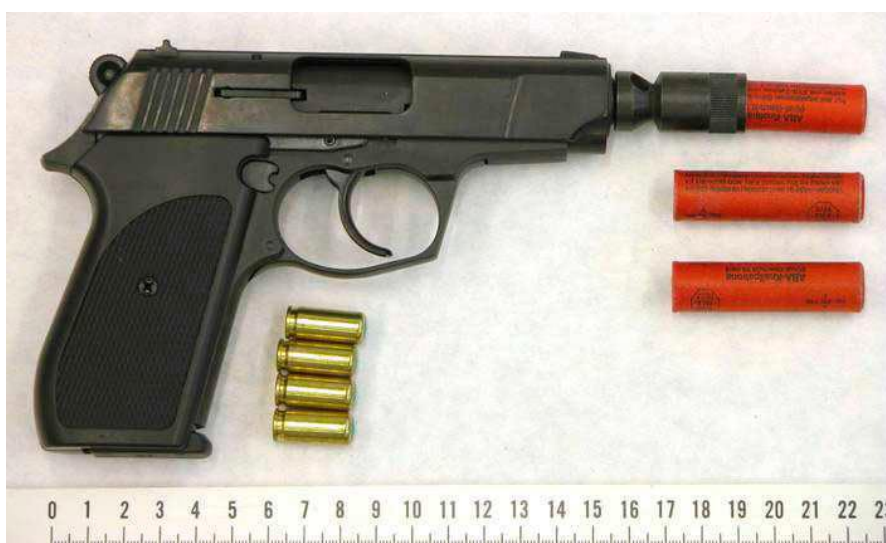
Foto 1. Gas-/alarmpistool met schietbeker, drie pyrotechnische patronen en vier knalpatronen.
